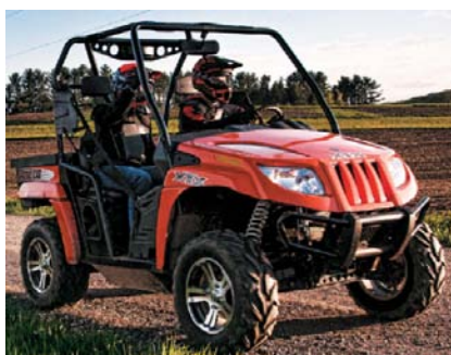
Obr. 4 Arctic Cat PROWLER s lichoběžníkovou nápravou vepředu i vzadu [16]
