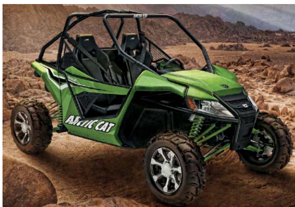
Obr. 19 Arctic Cat Wildfire s vnějším rámem [16]
