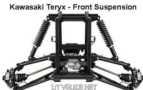
Obr. 3 Lichoběžníková náprava vozidla Kawasaki TERYX [6]
