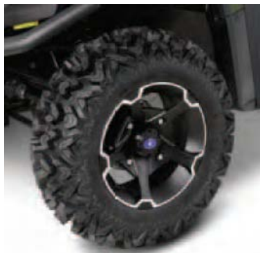
Obr. 27 Diskové kolo z hliníkové slitiny, Polaris Ranger [28]
