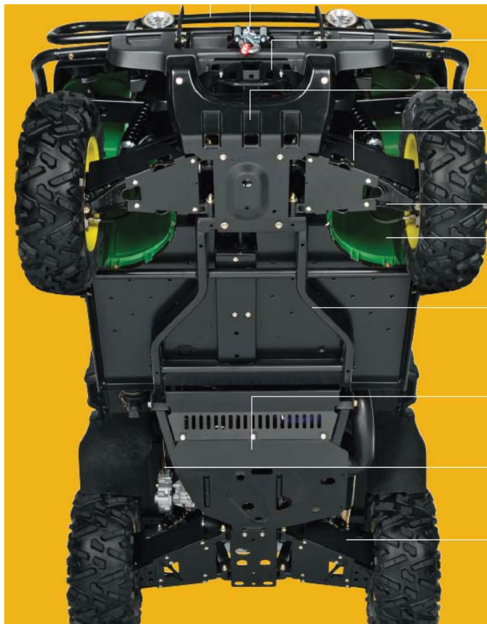
Obr. 20 Vnitřní rám vozidla John Deere Gator [23]
