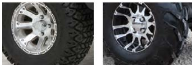
Obr. 26 Pneumatiky do různého terénu, New Holland Rustler [27] Zleva: univerzální, do bahnitého terénu
