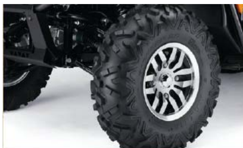
Obr. 24 Kolo: hliníkový disk a robustní pneumatika, Kawasaki TERYX4 [25]
