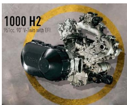
Obr. 30 V2 benzinový motor, Arctic Cat Prowler [16]
