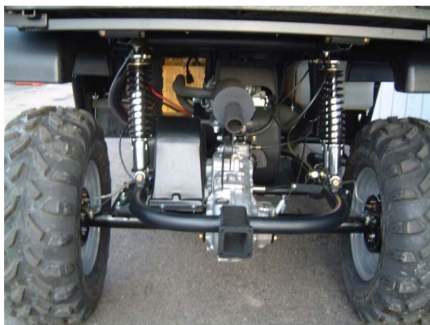
Obr. 15 Zadní kyvadlová náprava vozidla SportWorks Crew Cab [6]
