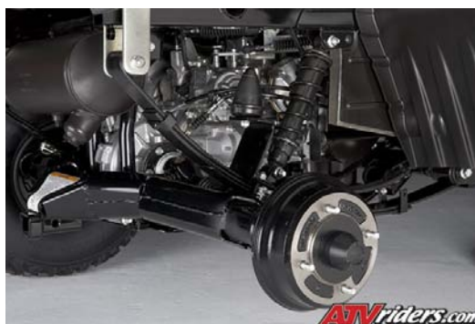
Obr. 9 Zadní zavěšení De Dion u vozidla Kawasaki MULE [7]
