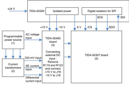
Figure 27. Setup Diagram
