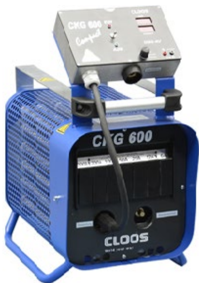
Ohmos műterhelés kalibrált műszerekkel
