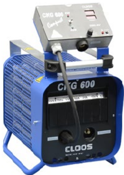
Ohmos műterhelés kalibrált műszerekkel
