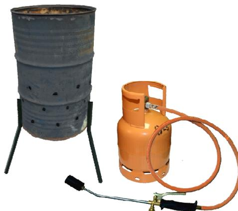
Predaja operateru za spaljivanje deaktiviranih preparata u tyvek ambalaži. Metalni vertikalni bubanj (kao bure od 200 lit.) sa rešetkastim dnom za uvođenje brenera za spaljivanje.
