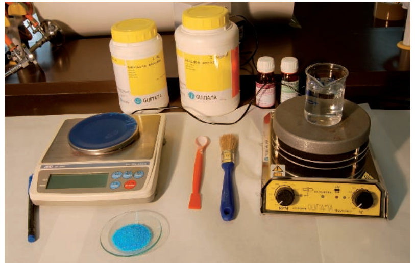
Fig. 1.6. Balanza (izquierda) y agitador (derecha) en la zona de elaboración de un laboratorio galénico.
