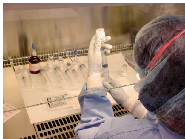
Fig. 1.8. Técnico con la vestimenta adecuada para trabajar en zonas limpias bajo campana de flujo laminar.
