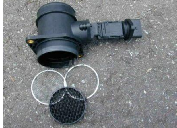
zerlegter LMM, Gehäuse mit eigentlichem LMM , Grobsieb, Feinsieb und Haltering für die Siebe
