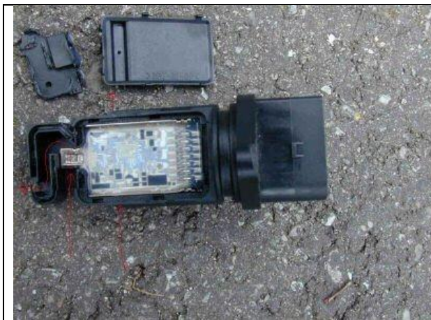
Luftzufuhr LMM Oberseite, durch den winkligen Luftkanal über die Heißfilmmessfühler
