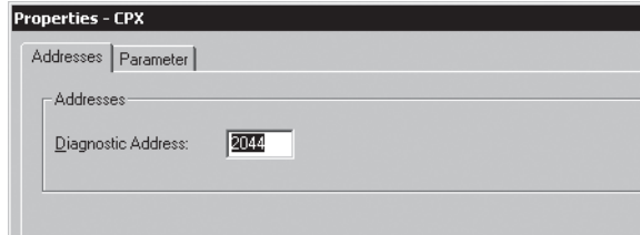
Fig. 2/12 : Modification de l'adresse de diagnostic à l'aide du logiciel Siemens STEP 7 – HW Config
