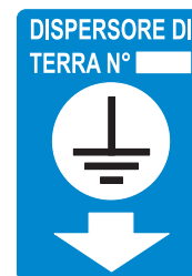
Segnale disposto in prossimità di un dispersore di terra.
