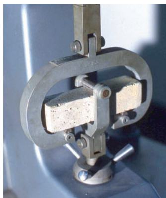
Prova di flessione su provino di calcestruzzo.
