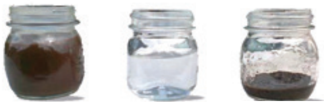
Margines (gauche) séparée par BlueVap en eau claire (milieu) et concentrat (droite)
