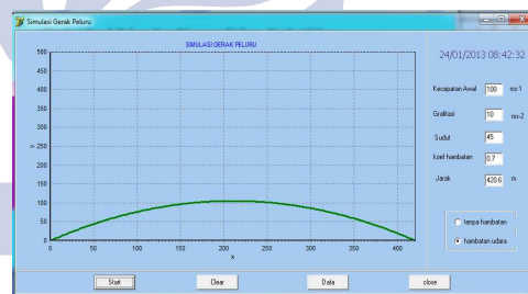
Gambar 9. Simulasi Grafik Gerak Peluru Yang Dipengaruhi Gaya Hambat Udara dengan kecepatan awal = 100 m/s, gravitasi = 10 m/s, sudut = 45 0 dan koefisien hambatan 1.
