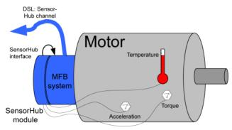
Figure 4: HIPERFACE DSL<sup>®</sup> SensorHub interface
