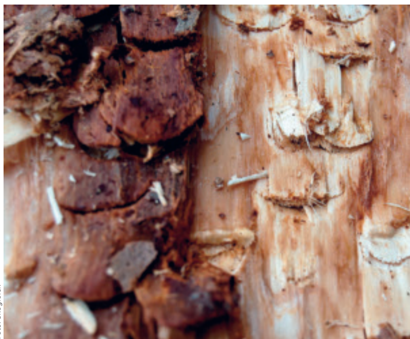
Figur 13. Dubbskador från ett aggregat med dubbförsedda stålvalsar.
