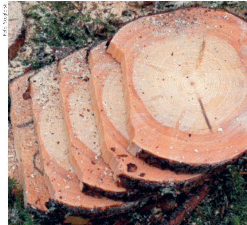
Figur 14. Illustration av trissmetoden. Trissorna är tagna ur en och samma stockände och genom att summera trissornas tjocklek kan kapsprickans längd uppskattas.
