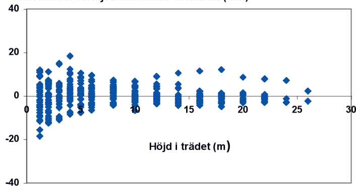
Figur 23. Residualerna (mätt dubbel barktjocklek minus beräknad) från a) Skogforsks tallfunktion, Sf-tall och b) Zaccos funktion för övergångsbark plottade mot höjd i trädet.
