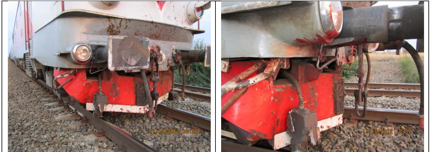
Fig. 2.48. Coliziunea LE 5100kW– cireadă de vaci la viteza de 100 km/h
