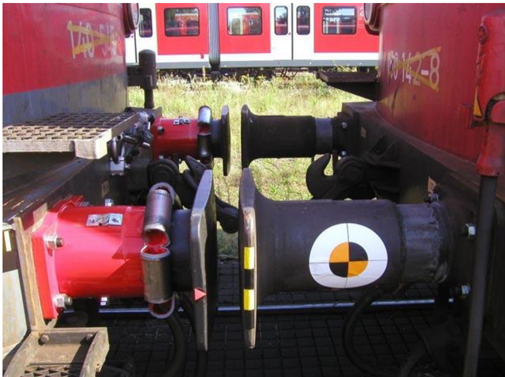
Fig. 2.10. Exemplu de acționare a tamponelor EST Duplex G1.A1 după un accident feroviar
