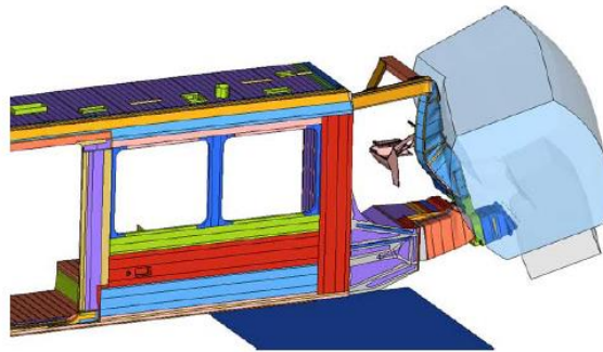
Fig. 2.19. Simularea scenariul 3 de coliziune, starea deformată [37]
