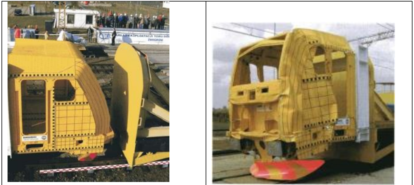
Fig. 2.23. Simularea unei situatii de coliziune frontală realizată cu o machetă a părții frontale a locomotivei TRAXX F140 AC2
