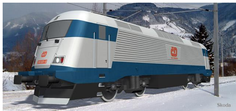
Fig. 2.25. Skoda 109E concepută pentru a satisface necesitățile EN15227 privind rezistența la impact
