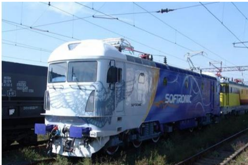
Fig. 2.33. Locomotiva electrică de 5100 kW Pheonix
