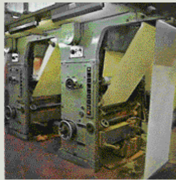
Una rotativa en funcionamiento. El papel que sale de la bobina pasa a través de varias unidades impresoras; después, máquinas automáticas lo cortan y lo pliegan.
