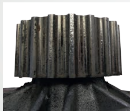
Pignon d'entraînement endommagé par la crasse et l'usure (dommage de palier)
