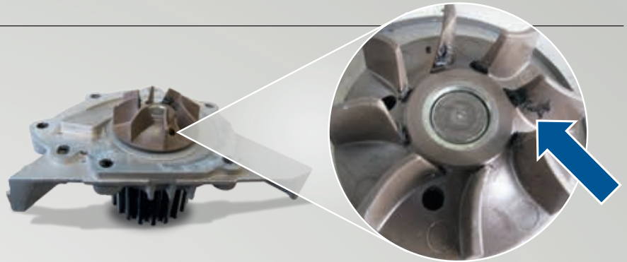
Pompe à eau devenue non étanche en raison d'un produit d'étanchéité liquide (la pompe a perdu son étanchéité encore pendant la montée en température)
