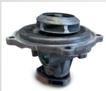
Dommage de palier dû à une tension trop élevée de la courroie
