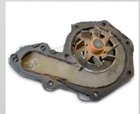
Utilisation excessive de produits d'étanchéité liquides (silicone dans ce cas)
