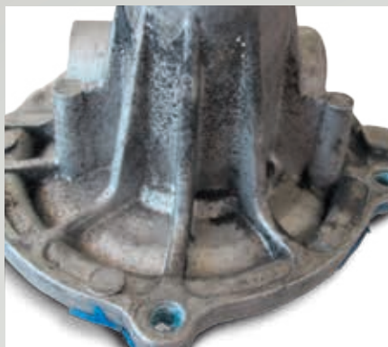
Dommage de palier dû à des problèmes de courroie (fragments de caoutchouc, particules sur le boîtier)
