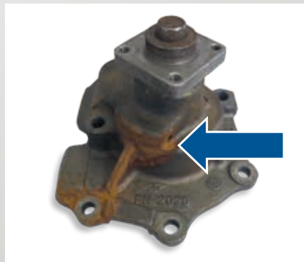
Pompe à eau devenue non étanche en raison d'un liquide de refroidissement chargé de rouille (mauvaise protection anticorrosion du liquide de refroidissement)
