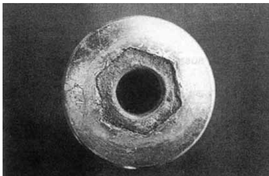
Fig. 1.3-4 Crevice corrosion in SUS 316L
