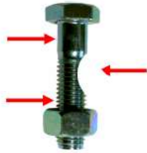
Tipe keruntuhan tumpu pada baut.
