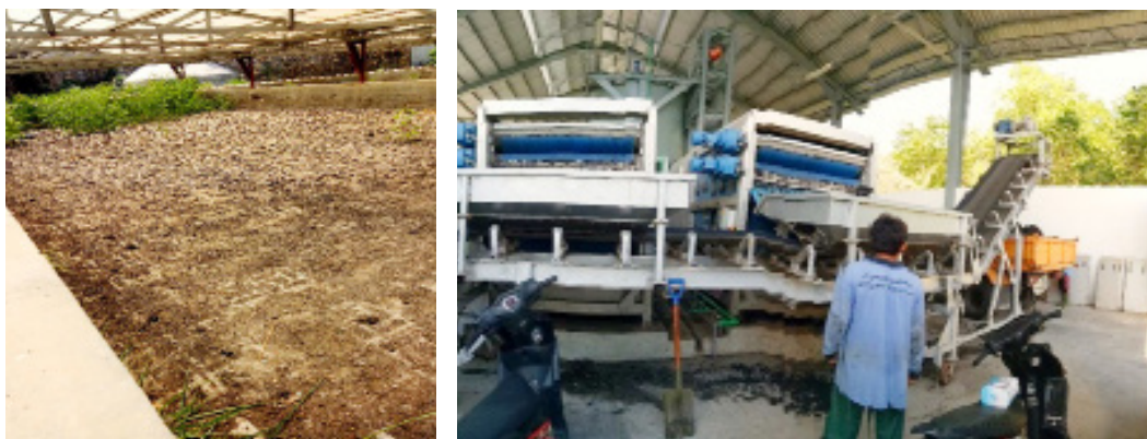
Gambar 6-8 Unit pengeringan lumpur bervariasi, bisa menggunakan Sludge Drying Bed , Belt Filter Press , atau teknologi lainnya
