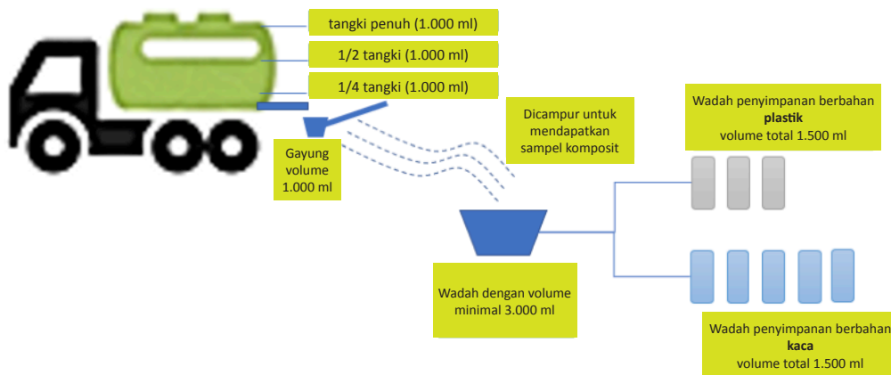
Gambar 5.1 Tata cara pengambilan sampel lumpur tinja
