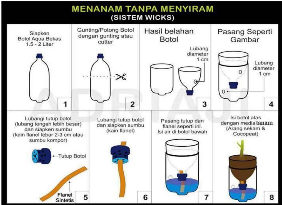
Gambar 20. Langkah-langkah Membuat Media Tanam Sayuran Hidroponik Sistem Wicks (Sumber: .....)
