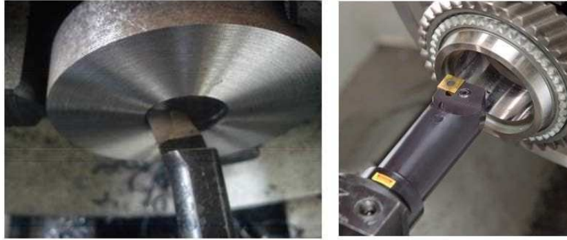
Gambar 3.7 Membubut dalam/ boring
