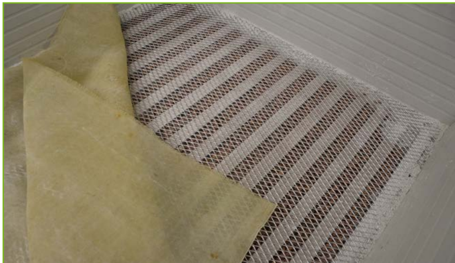
Obrázek 19. Nahřívací dno termoboxu. Odporový kabel je zalit betonem v roštu pozinkovaných profilů, tím je zabráněno jakémukoliv poškození elektroinstalace při manipulaci s nářadím. Na roštu je umístěna síť z tahokovu, která rozvádí teplo. Na ní leží silonová síťka bránící propadávání jemného perlitu.
