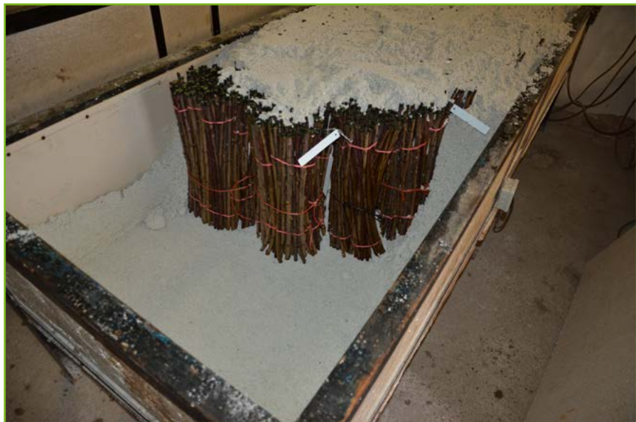
Obrázek 21. Postupné zakládání balíků dřevitých řízků do termoboxu a zasypávání perlitem před tepelnou stimulací.
