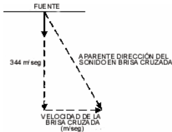
Figura 1-10. Efecto de brisa cruzada en la aparente dirección del sonido.
