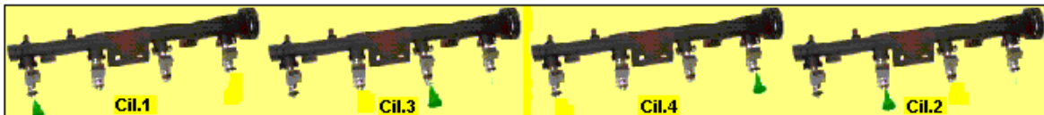
Cada media vuelta de cigüeñal abre el inyector correspondiente al cilindro que está en fase de admisión
