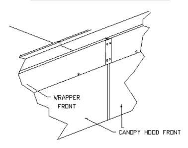
FIG.6 FRONT WRAPPER JOINT ASSEMBLY
