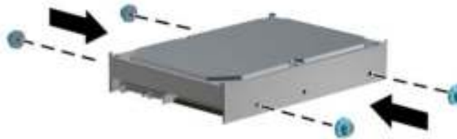
Afbeelding 4-37 Geleideschroeven van de vaste schijf monteren
