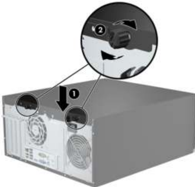
Afbeelding 3-3 Duimschroeven van toegangspaneel vastdraaien
