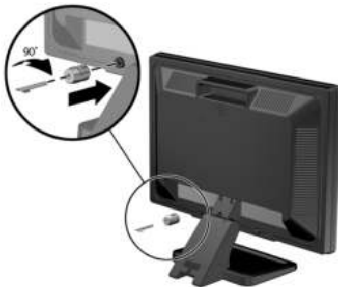
Afbeelding 3-35 Het kabelslot op de monitor installeren
