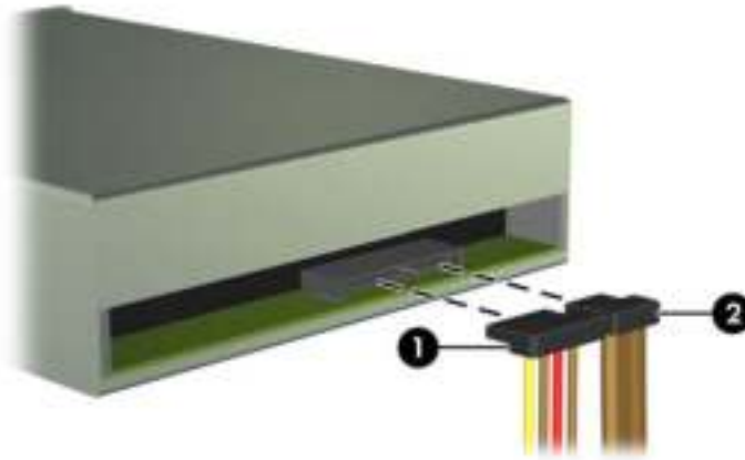
Afbeelding 4-19 Gegevenskabel en voedingskabel loskoppelen
