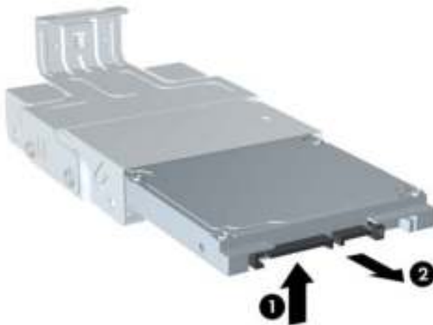
Afbeelding 5-18 Vaste schijf uit houder verwijderen
