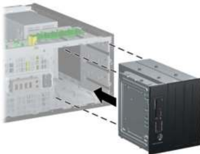
Afbeelding 2-37 Schijfeenheid installeren in een minitowerconfiguratie
