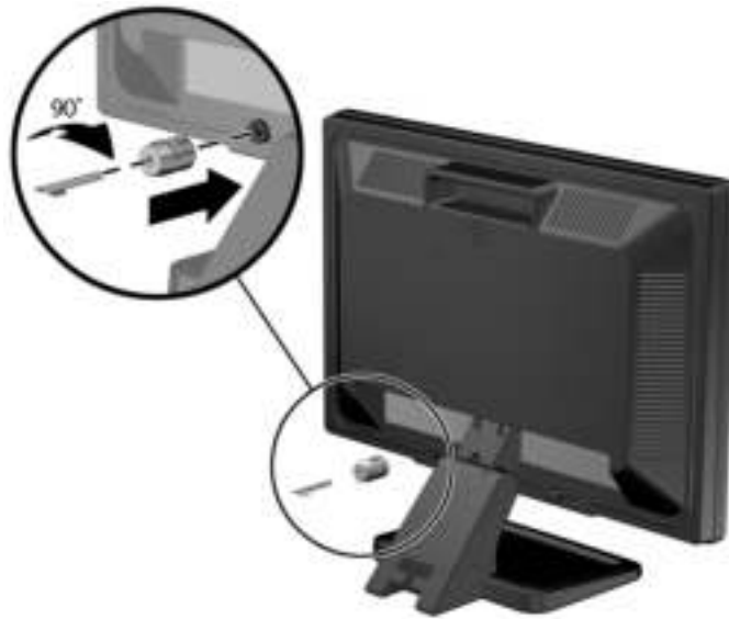
Afbeelding 4-43 Het kabelslot op de monitor installeren
