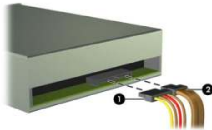
Afbeelding 2-14 Kabels van de optischeschijfeenheid loskoppelen
