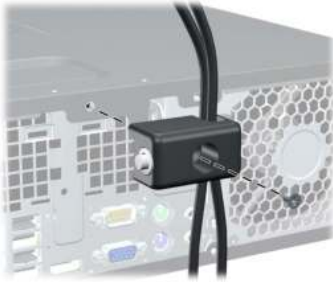
Afbeelding 4-47 Slot aan het chassis bevestigen
