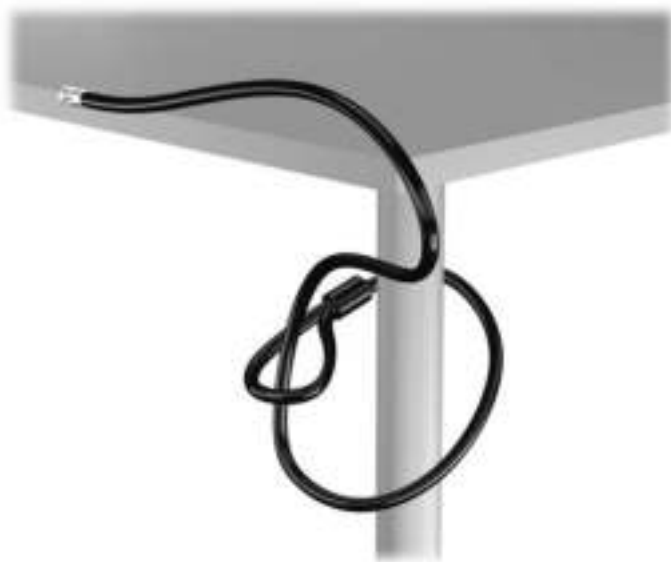
Afbeelding 3-34 Kabel bevestigen aan een vast object
