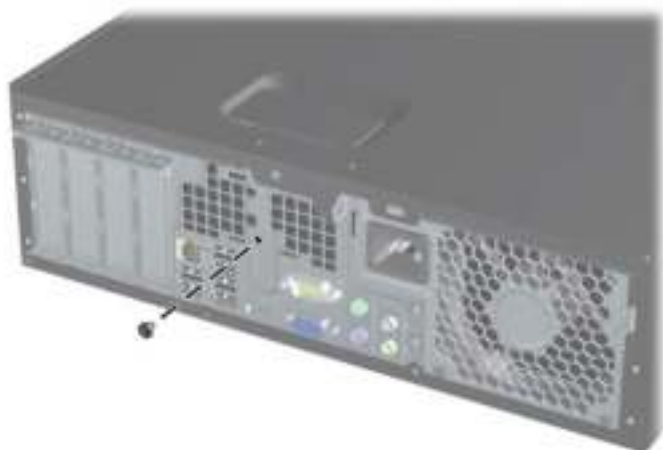
Afbeelding C-3 De Smart Cover-vergrendelschroeven van de Small Form Factor verwijderen
