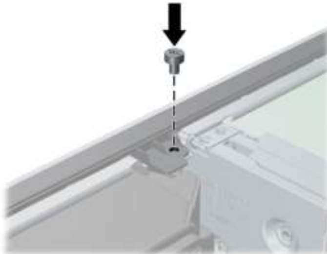
Afbeelding 4-51 Bevestigingsschroef van voorpaneel bevestigen
