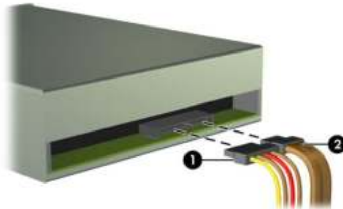
Afbeelding 3-22 Kabels van de optischschijfeenheid aansluiten
