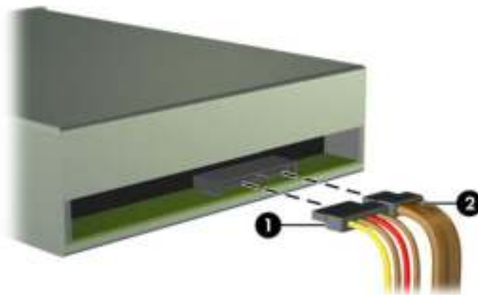
Afbeelding 3-17 Kabels van de optischschijfeenheid loskoppelen
