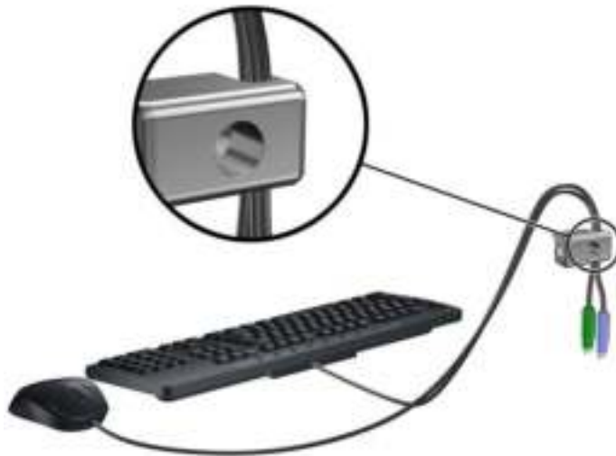
Afbeelding 2-45 Toetsenbordkabel en muiskabel door het slot voeren
