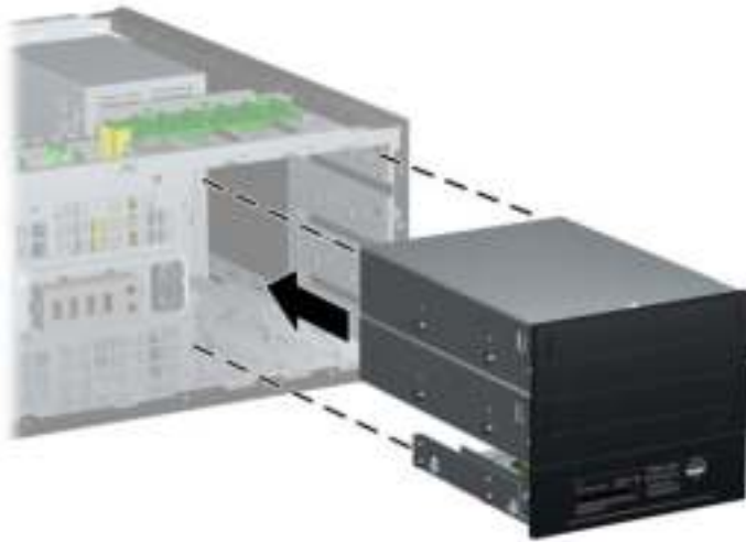
Afbeelding 2-34 Schijfeenheid installeren in de desktopconfiguratie
