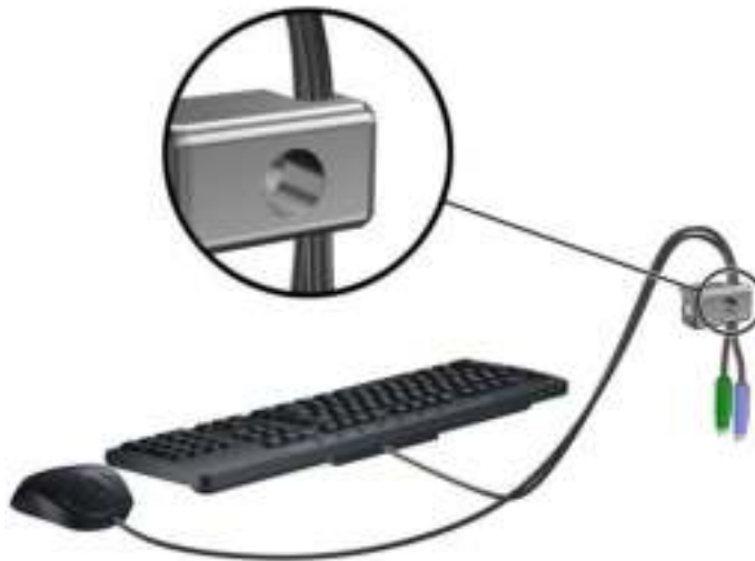
Afbeelding 5-31 Toetsenbord- en muiskabel door het slot voeren
