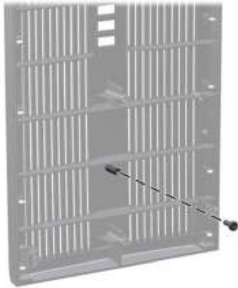
Afbeelding 2-49 Beveiligingsschroef uit het voorpaneel halen
