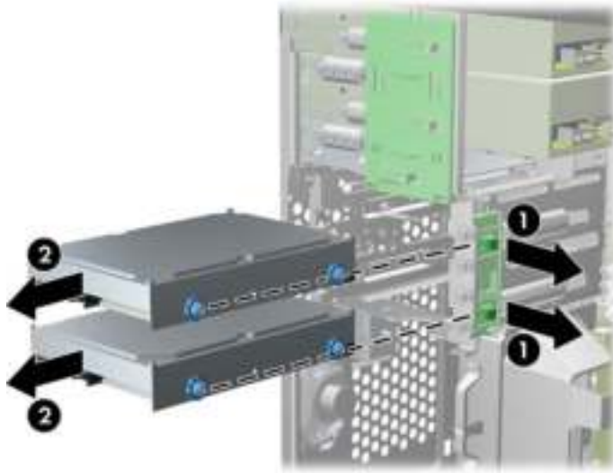
Afbeelding 3-25 Vaste schijf verwijderen
