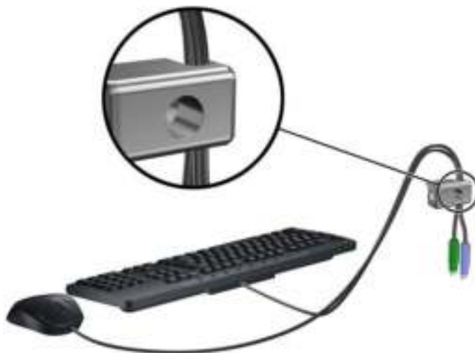
Afbeelding 4-46 Toetsenbord- en muiskabel door het slot voeren
