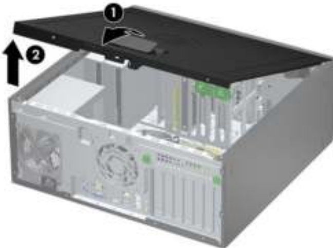
Afbeelding 2-1 Toegangspaneel van de computer verwijderen
