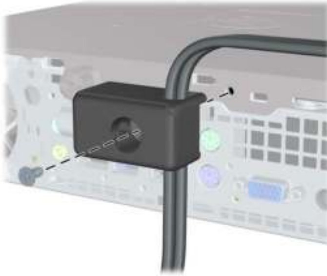
Afbeelding 5-32 Slot aan het chassis bevestigen
