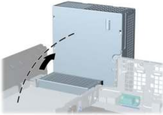
Afbeelding 4-35 Kabels van de vaste schijf loskoppelen
