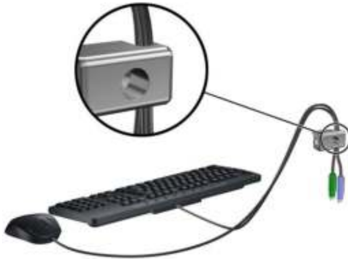
Afbeelding 3-38 Toetsenbordkabel en muiskabel door het slot voeren
