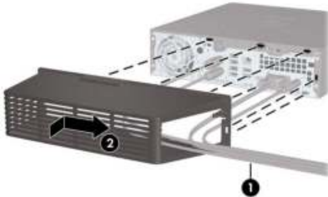
Afbeelding 5-22 Afdekkapje voor de poorten installeren
