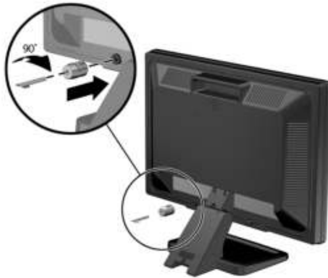
Afbeelding 5-28 Het kabelslot op de monitor installeren
