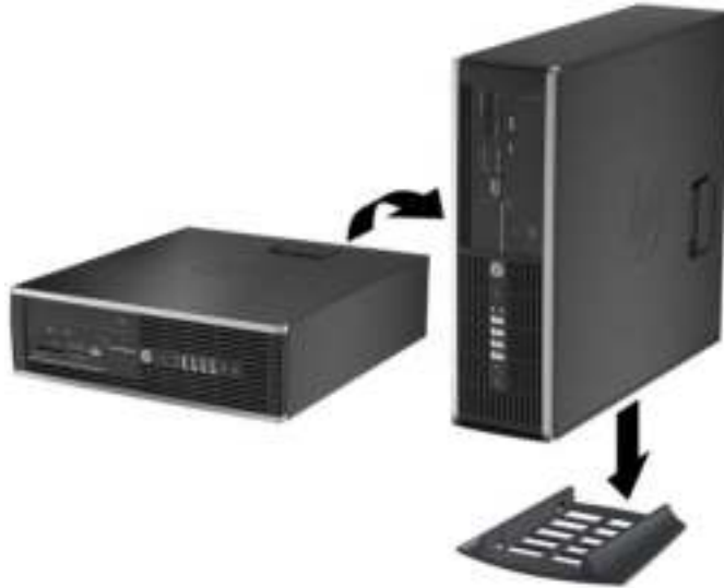
Afbeelding 4-6 Desktopconfiguratie omzetten in torenconfiguratie
