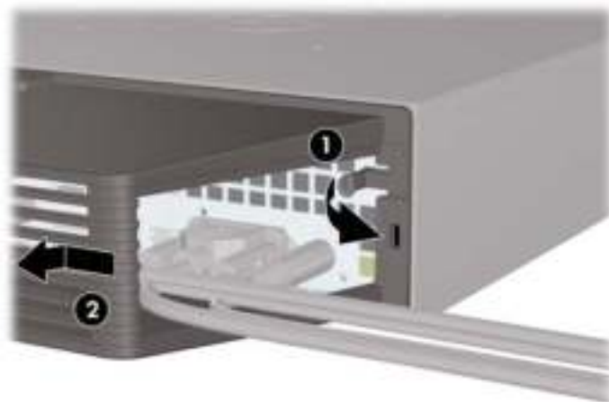
Afbeelding 5-23 Afdekkapje voor de poorten verwijderen
