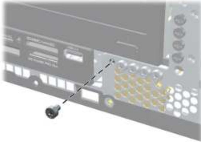
Afbeelding 4-50 Beveiligingsschroef uit het voorpaneel halen
