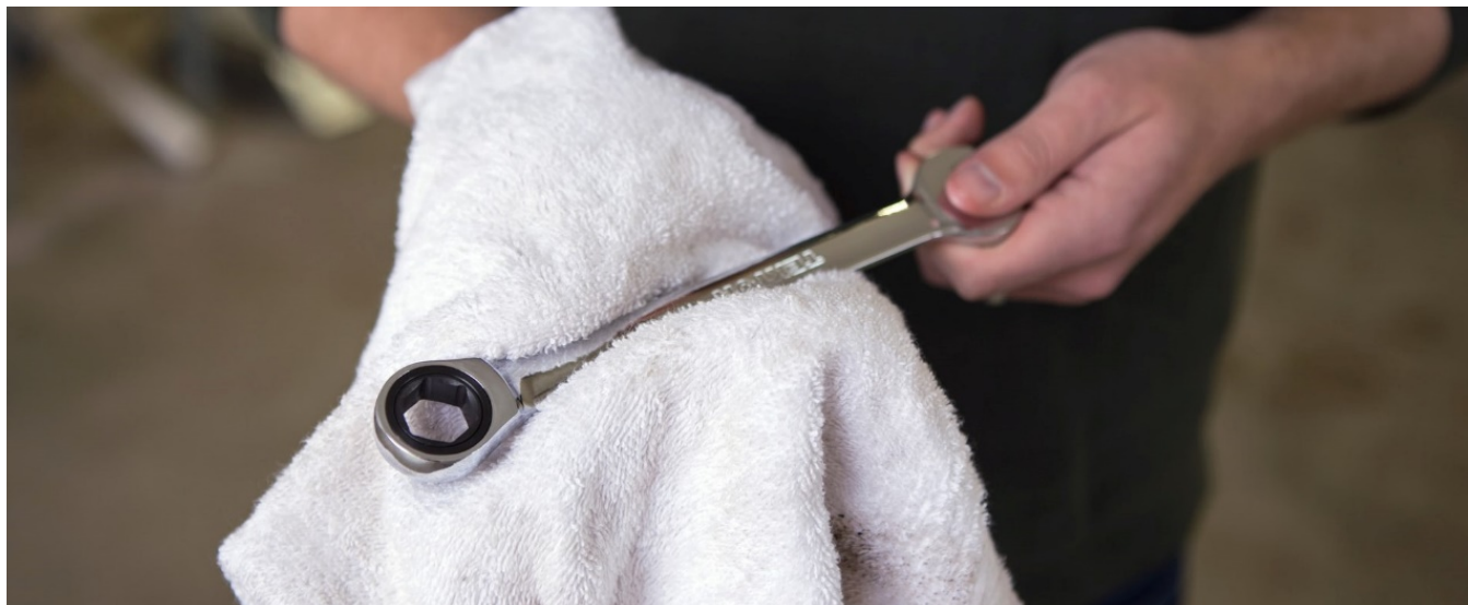
Figura 2: Las toallas de taller puede designarse como desechos peligrosos.
