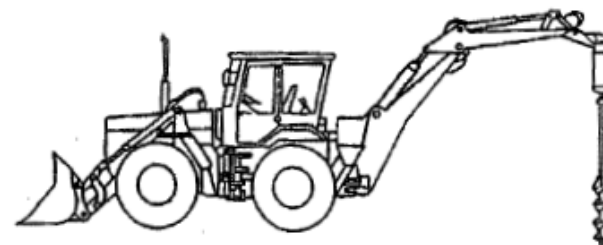
Esempio di terna con trivella
