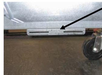
Afbeelding 1: Bevestig de linieerbeugel aan de onderkant van de ATO-kastbeugel.
