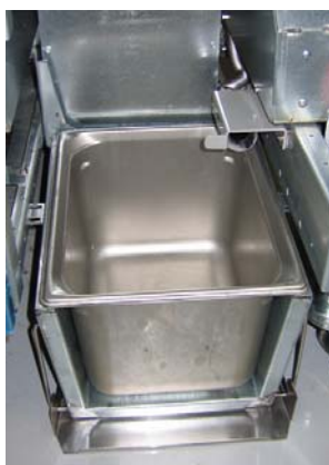
Afbeelding 3: Plaats de binnenste oliereservoirpan in de smelter.
