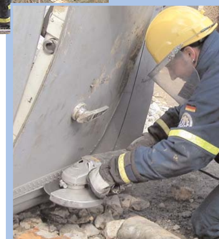
THW-Helfer Bernd Müller flext die Tür der abgestürzten Maschine ab. Sie ließ sich nicht mehr schließen und behinderte beim Verladen des Wrackteils.
