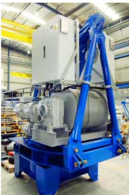
Insgesamt sind sechs Modelle (11 LC 90 5t, 11 LC 90 6t, 11 LC 132 5t, 11 LC 132 6t, 11 LC 150 8t und 11 LC 160 8t) verfügbar. Die Krane mit 5 t besitzen Hubwerke von 18 kW mit Polumschalter oder mit Frequenzregelung; die Ausführungen mit 6 t besitzen Hubwerke von 24 kW und optional 37 kW mit Frequenzregelung. Krane mit 8 t verfügen über Hubwerke von 24 kW, optional 37 kW und 45 kW mit Frequenzregelung. Das neue 45-kW-Hubwerk hat eine Seilkapazität von 1000 m,
