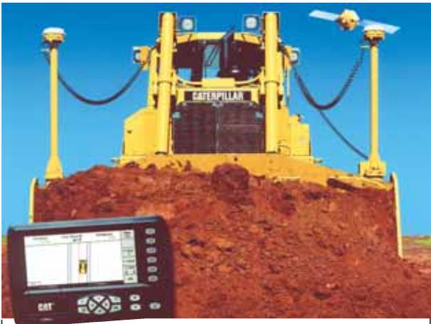
**Vernetzter Bau:** Das Maschinensteuerungssystem AccuGrade von Caterpillar macht die millimetergenaue Herstellung der gewünschten Geländekontur ohne Vermessungsarbeiten möglich.
