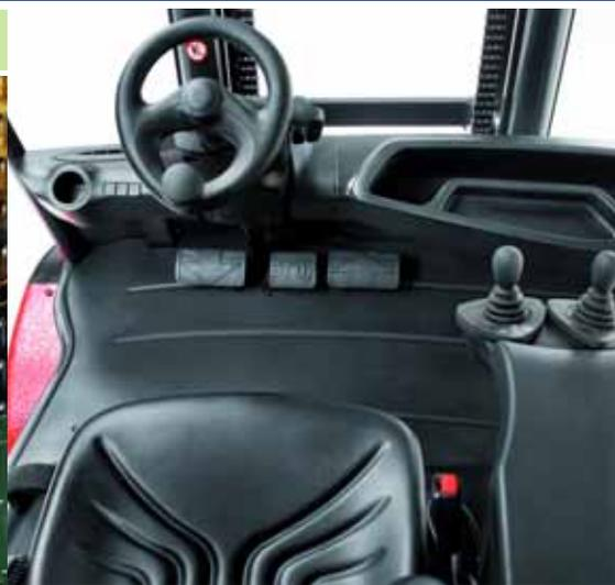
▲ **Fingerleichter Hub:** Für mehr Bedienkomfort sorgt die Linde-Load-Control zur Steuerung der Mastfunktionen.
