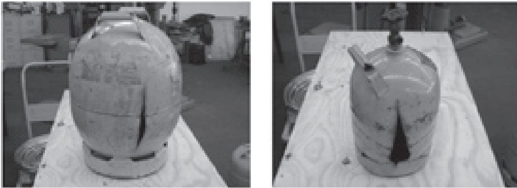
Figura 27. Imágenes de cilindros con falla por sobrellenado
