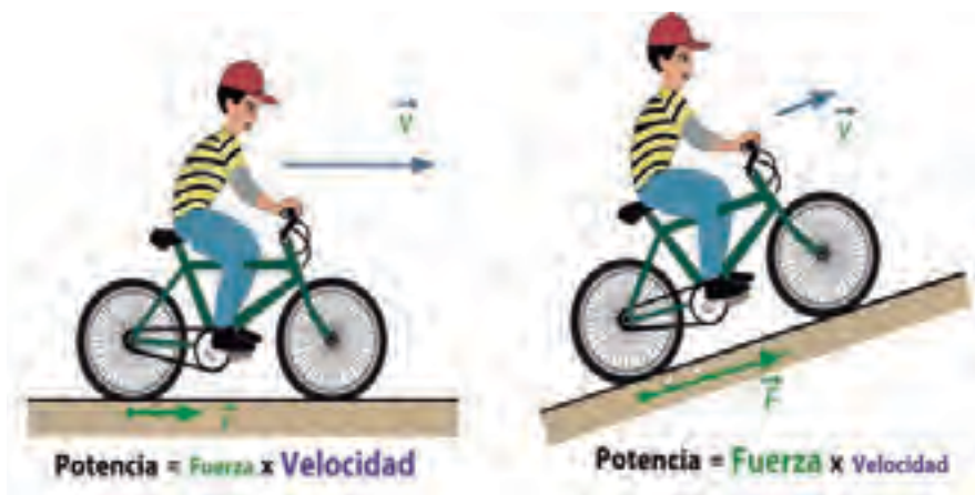
Figura 27.5. Igual potencia en los dos casos, mucha fuerza poca velocidad y viceversa.
