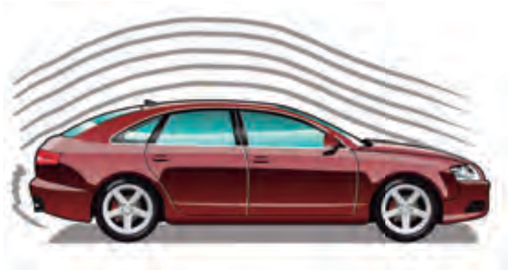
Figura 29.8. Al igual que para el avión, el fluido en el cual se mueve el automóvil es casi incompresible, a velocidades inferiores a la velocidad del sonido.
