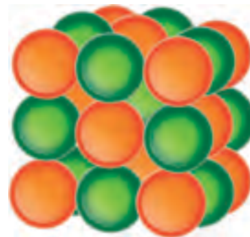
Figura 24.2. Estructura de los cristales de cloruro de sodio (NaCl). Red cristalina (lado izquierdo) y estructura tridimensional (lado derecho).
