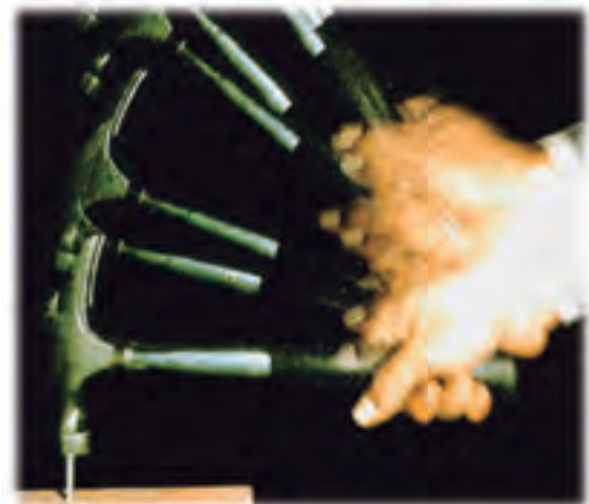
Figura 29.14. Cuando menor sea el área sobre la cual actúa una fuerza, tanto mayor será la presión que produzca. Esta es la razón por la cual al usar el martillo podemos con facilidad penetrar la madera con el clavo.
