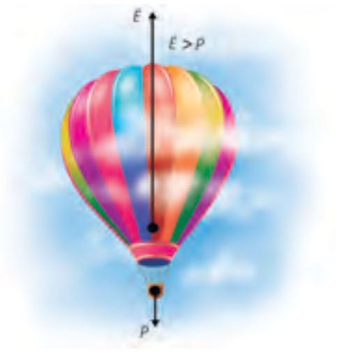
Figura 30.26. Un globo aerostático sube en la atmósfera gracias al empuje ascendente que recibe del fluido (aire).
