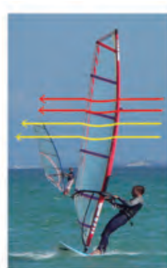
Figura 29.11. Gracias al principio de Bernoulli, el efecto del viento sobre la vela produce una diferencia de presión que “absorbe” al windsurfer hacia la zona de baja presión a gran velocidad.
