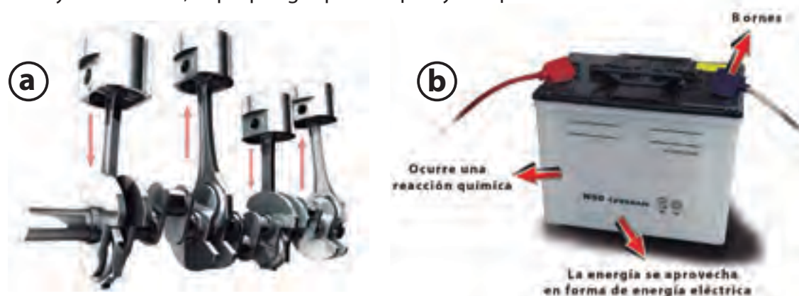
Figura 22. 11. Algunos elementos necesarios para hacer funcionar el motor de un vehículo. Los pistones ubicados dentro del motor (a) y la batería que permite generar la chispa en las bujías (b).
