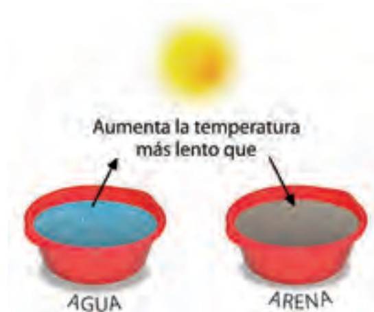
Figura 28.5. En el día la arena aumenta su temperatura más rápido que el agua, y al revés, en la noche disminuye su temperatura más rápido, debido a su diferencia en el calor específico.
