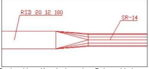
Rechteckiges Kanal mit rundem Rohr verbinden
