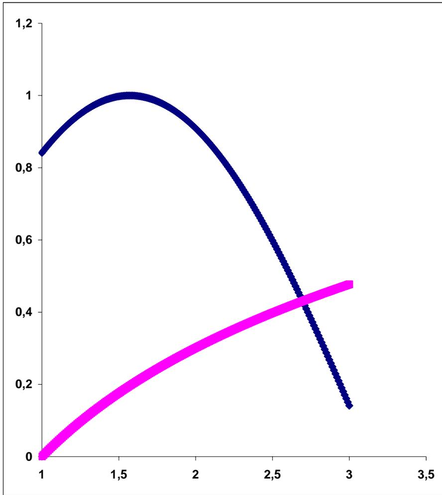
Evidentemente en el mencionado intervalo ambas curvas se cortan y por tanto la función  $f(x) = \text{sen}x - \log x$  tiene un cero, el cual se puede acotar más al intervalo  $[2,5 ; 3]$
