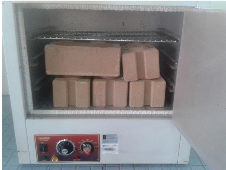
Rajah 3.2 Sampel dikeringkan dalam oven selama 48 jam pada suhu 110°C
