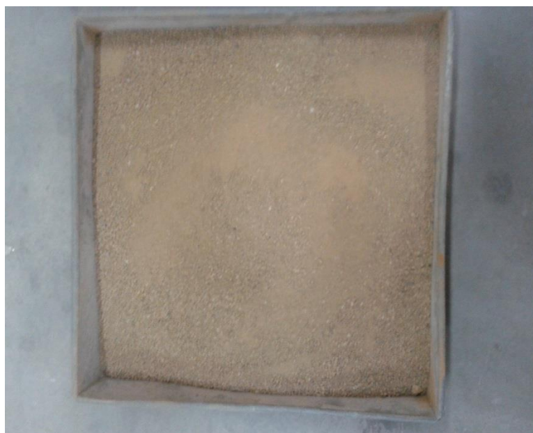
Rajah 3.5 Tanah yang telah siap digredkan digunakan untuk adunan sampel
