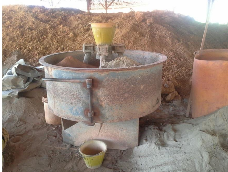
Rajah 4.6 Mesin pengadun yang digunakan di kilang
