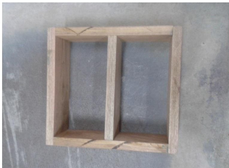
Rajah 3.6 Acuan yang digunakan untuk hasilkan sampel di makmal
