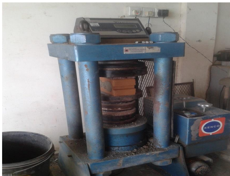
Rajah 3.3 Ujian Kekuatan Mampatan yang dilakukan di Makmal Q Pile, Babena
