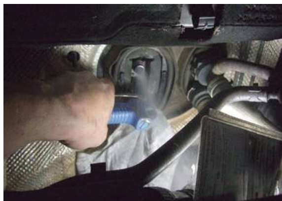
Fazer a limpeza com nitrogênio comprimido
