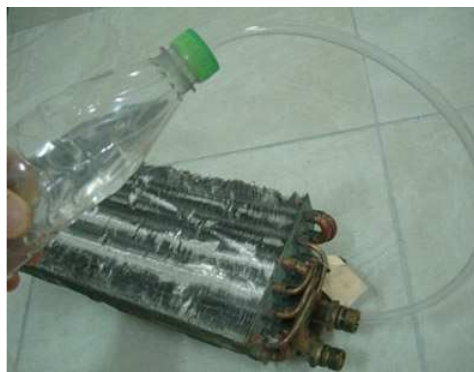
Ferramenta artesanal com o fluido R-141B
