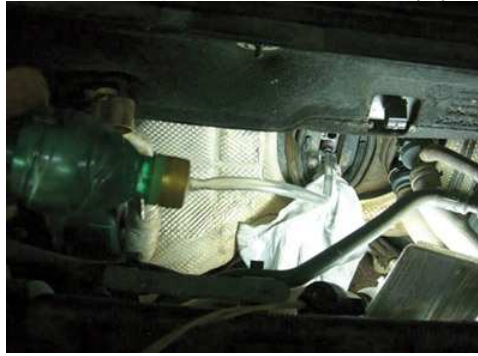
Ferramenta artesanal em ação com o fluido R-141B
