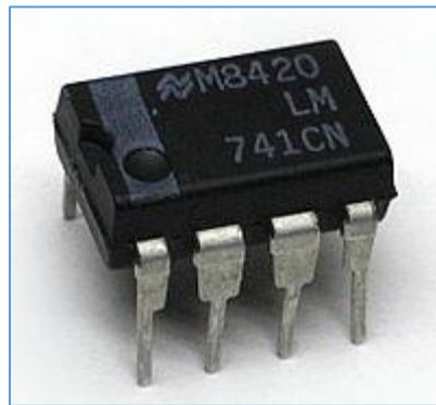
Ilustración 1 Amplificador operacional modelo LM741CN de National Semiconductor con encapsulado plástico DIP.
