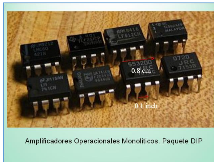
Ilustración 6 Se muestra los tipos de amplificadores monolíticos con un encapsulado DIP y sus respectivos seriales.
