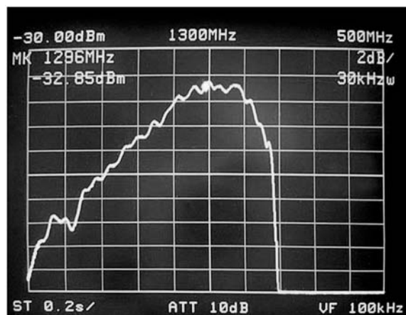
Fig. 4: Sweeping the 47 element yagi max. gain at 1299 MHz - Wobbelkurve der 47-Element-Yagi, Gewinnmaximum bei 1299 MHz
