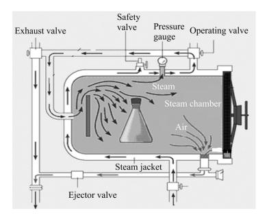
Fig. 4.1: An Autoclave
