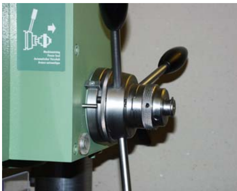
Bild 2. Inskjuten koppling Picture 2. Inserted coupling Abb. 2. Hineingeschobene Kupplung
