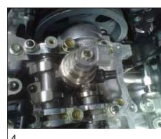
Miután rögzítettük a szerszámot az injektorhoz, rögzítsük a csapszeget a lebegő földelésre az M10 szegnél, majd kezdjük meg az injektor manuális eltávolítását lebegő földeléssel. (9. kép).
