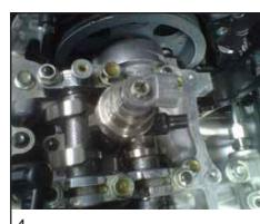
Depois de fixada a ferramenta no injetor, atarraxar o perno com extrator de impacto no prisioneiro M10 e prosseguir com a extração do injetor atuando manualmente com extrator de impacto (fig. 9).
