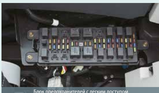
Блок предохранителей с легким доступом
