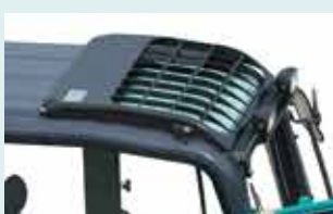
Защита потолочного стекла устанавливается по отдельному заказу (ISO 10262:1998).
