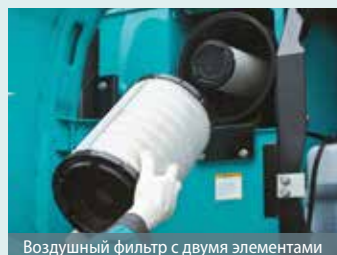
Воздушный фильтр с двумя элементами
